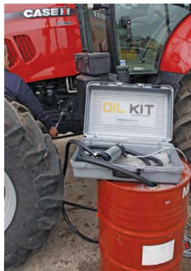
Переносная установка для перекачивания масла, укомплектованная насосом с питанием от аккумуляторной батареи и электродвигателем на 12 В или 24 В постоянного тока. Благодаря своим компактным размерам, надёжности, лёгкости в использовании и энергонезависимости позволяет осуществить перекачку или заправку масла без наличия питания от электросети. Переносная установка OIL KIT идеально подходит для заправки строительной техники и для использования в автосервисах.
