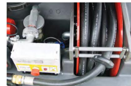
Электрический щит и катушка с пружинным приводом.
