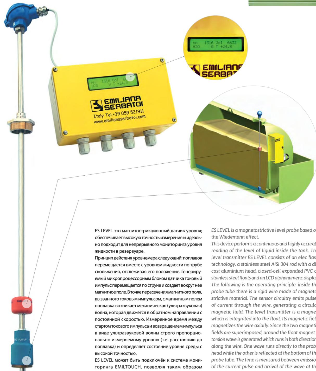
ES LEVEL это магнитоотрицательный датчик уровня; обеспечивает высокую точность измерения и идеально подходит для непрерывного мониторинга уровня жидкости в резервуаре.
