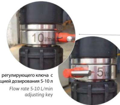
регулирующего ключа с функцией дозирования 5-10 л
