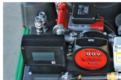
Система Emilprobe®, механический счётчик и БРС для подключения к генератору.
