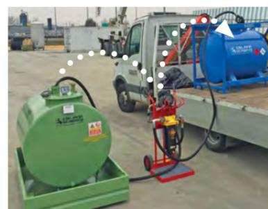
Мобильная установка Emil-filter позволяет очистить топливо от воды и примесей: эта двойная функция выполняется с помощью двух фильтров: один на всасывающей линии и второй на подающей линии. Всё оборудование установлено на тележке, изготовленной из металлических труб, покрашенных красной краской, с двумя проколостойкими колёсами и подставками для намотки рукавов, кронштейном для установки электронасоса и поддоном для сбора пролива. В наличии также бензиновое исполнение.
