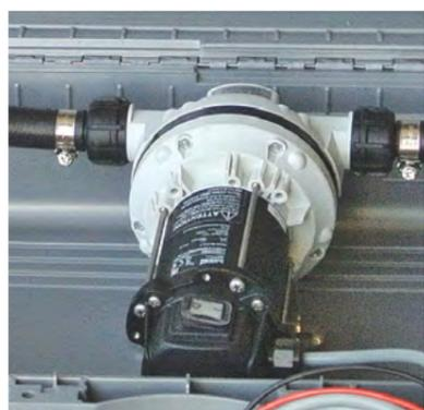
Переносная установка для перекачивания жидкости AdBlue®, укомплектованная электронасосом с питанием от аккумуляторной батареи и электродвигателем на 12 В или 24 В постоянного тока. Благодаря своим компактным размерам, надёжности, лёгкости в использовании и энергонезависимости позволяет осуществить перекачку или заправку жидкости AdBlue® без наличия питания от электросети. Переносная установка AdBlue® Kit идеально подходит для заправки автотранспорта, сельскохозяйственной и грузовой техники.
